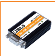
USB encoder interface E201-9Q
